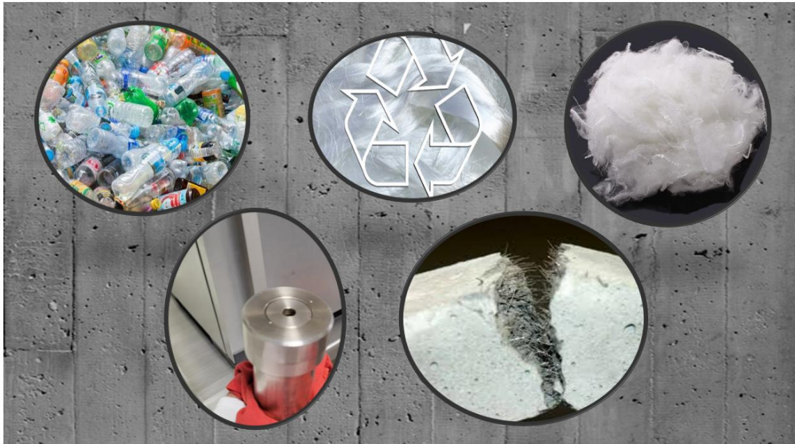
Figura 3. Fibra de PET como refuerzo en concreto. Fuente: elaboración propia.
